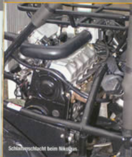
Dalton Extreme 1.100: Klassischer Buggy mit Gitterrohrrahmen und Pkw-Motor
